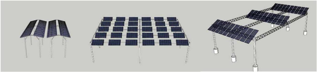
Bild 44: Illustration verschiedener Anlagentypen mit Ost-West-, Süd- und Süd-Ost-Ausrichtung. © Fraunhofer ISE
